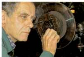
Nach der Demontage des Rads wird die Fettkappe entfernt. Unter ihr verbirgt sich die durch einen Splint gesicherte Kronmutter. Der Bremsattel wird demontiert (zumindest über eine Kolben zurückgesetzt), um das Laufgeräusch der Lager korrekt einschätzen zu können. Wir zogen die Mutter mit dem werkseitig vorgegebenen Drehmoment an. Das Lagerspiel war anschließend korrekt, die Laufgeräusche blieben jedoch. Einzige Lösung: Radlager austauschen
