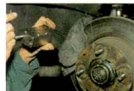
Nach der Demontage des Rads wird die Fettkappe entfernt. Unter ihr verbirgt sich die durch einen Splint gesicherte Kronmutter. Der Bremsattel wird demontiert (zumindest über eine Kolben zurückgesetzt), um das Laufgeräusch der Lager korrekt einschätzen zu können. Wir zogen die Mutter mit dem werkseitig vorgegebenen Drehmoment an. Das Lagerspiel war anschließend korrekt, die Laufgeräusche blieben jedoch. Einzige Lösung: Radlager austauschen
